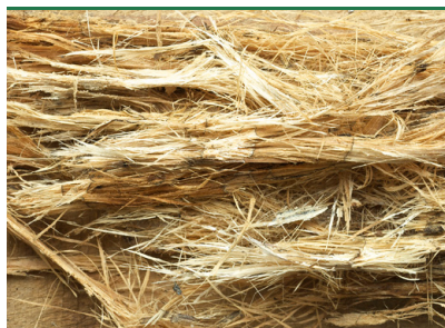
Hvidmuld - svampen nedbryder ligninen i træet og efterlader cellulosetrådene. Derved trævler træet.
