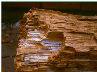
Hvid Tømmer-svamp - sprækkeklodser. (Foto: Goritas A/S)
