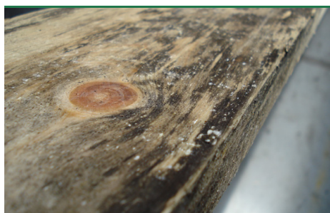
Blåsplint og sortskimmel på nåletræ. (Foto: Protox)
