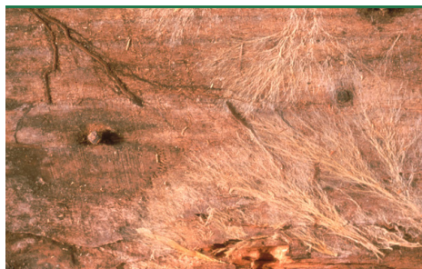
Gul Tømmersvamp - karakteristisk mørkt og lyst strengmycelium. (Foto: Protox/Gori)
