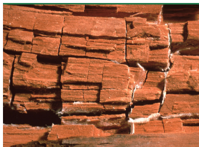
Brunmuld - svampen nedbryder cellulosefibrene og efterlader ligninen.
